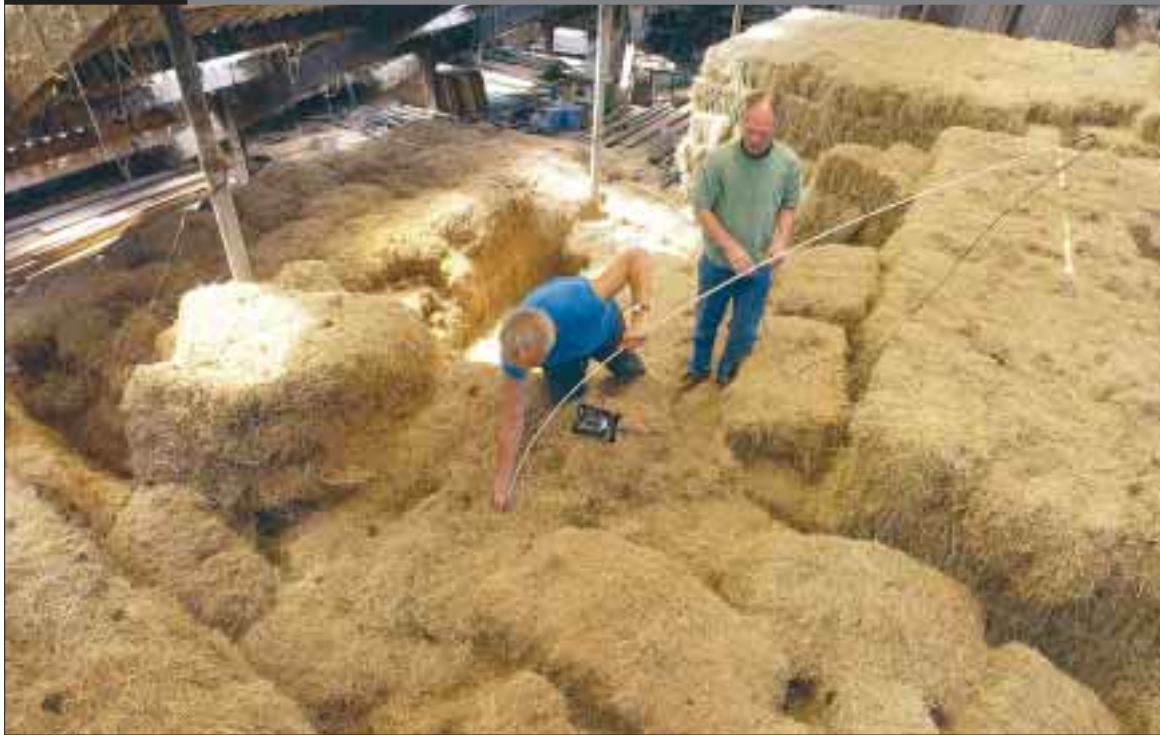
EEN MEDEWERKER VAN VERZEKERAAR INTERPOLIS meet de temperatuur in een hooiopslag in Heeg. De controle is preventief. In de zomer is de kans op brand door hooibroei reëel aanwezig. NILES DE VRIES/ANP
